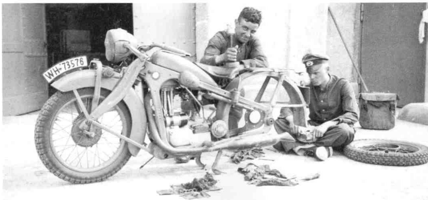
Auch die völlige Beherrschung der Kfz-Technik gehörte zum Ausbildungsprogramm der Kradfahrer. Daher muss sich die Teil-Zerlegung dieser R 4 nicht durch eine technische Störung begründet haben. Expertise in repairing and maintaining the motorcycle is part of the training for a dispatch rider. A soldier during technical routine. (HH)
