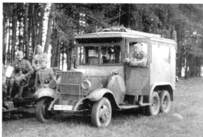
Ein Funkbetriebs-Kraftwagen Kfz. 62, erkennbar an der ausfahrbaren Antenne, auf Mercedes-Benz G 3a. Leider konnte die Zugehörigkeit nicht geklärt werden, Truppenkennzeichen ist ein Hufeisen. A Funkbetriebs-Kraftwagen Kfz. 62 Mercedes-Benz G 3a signals van. Note the retractable antenna mast and the horseshoe marking of an unknown unit. (HH)
