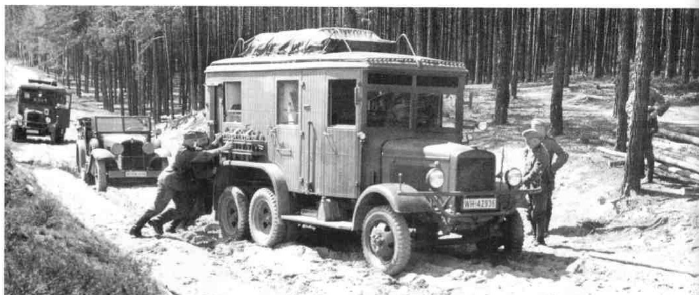
Ein Kfz. 61 auf Magirus M 206 mühte sich im Mai 1938 durch den märkischen Sand. Dahinter erkennt man einen Kübelwagen Stoewer M 12, gefolgt von einem Büssing-NAG G 31.
