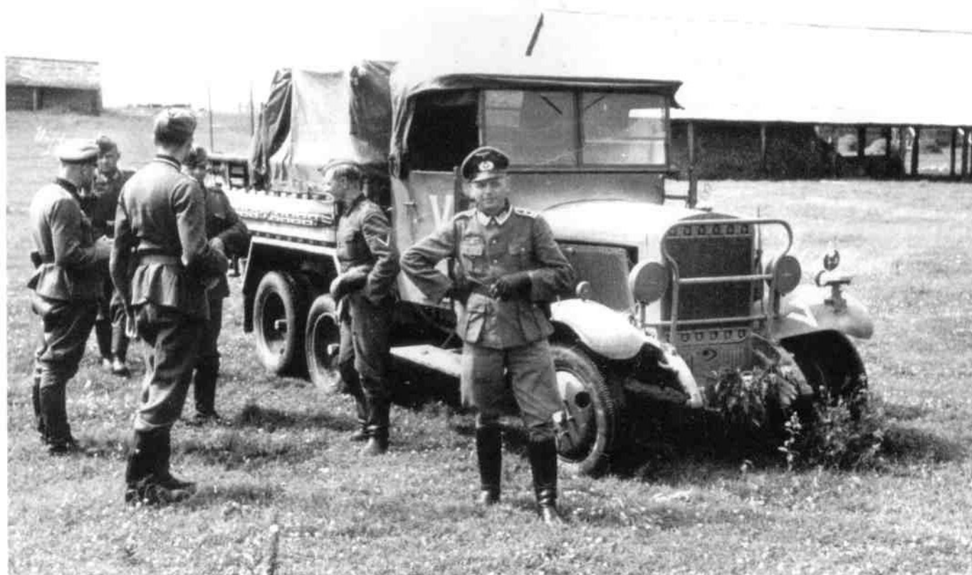
Dieser Mercedes-Benz G 3a trägt das spätere und typische faltverdeck. Der Wagen, als Veteran noch als Trossfahrzeug dienend, wurde nach 1939 mit einem Notek-Tarnscheinwerfer nachgerüstet. Das „V“ steht für „Versorgung“. This Mercedes-Benz G 3a is fitted with the mentioned foldable soft-top. The truck, serving here already as a veteran, had been re-fitted with a Notek blackout-driving light after 1939. The „V“-marking stands for „Versorgung“ - supply. (DT)
