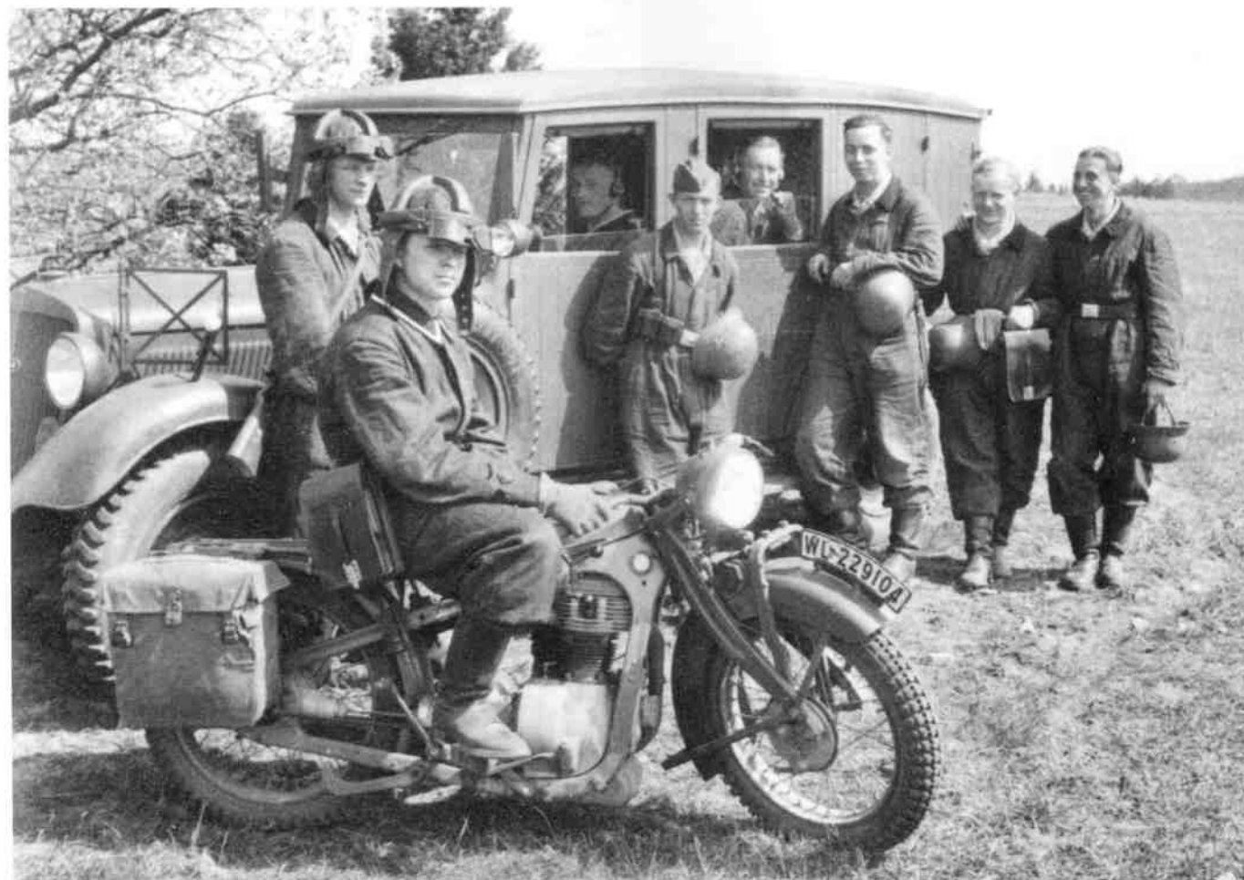
Die Krad-Melder einer Flak-Abteilung haben sich bei dem von der Luft-Nachrichtentruppe betriebenen Kfz. 17, Kleiner Funkkraftwagen auf Horch 830 R, versammelt, um die hier per Funk eingehenden Befehle umgehend an die weit verteilt aufgestellten Batterien überbringen zu können. These dispatch riders of an anti-aircraft gun unit gathered in front of a Luftwaffe signals unit's Horch 830 R Kleinwagen Kfz. 17 to receive incoming messages and distribute them to the units scattered in the region. (HH)
