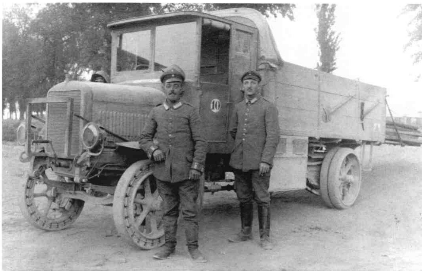
Seit 1912 in Frankfurt/Main in Serie hergestellt wurde der Adler 4 to-Subventionstyp. 1917 fotografiert, ist die gummi-sparende Notbereifung der Vorderräder bemerkenswert, eine Behelfslösung aufgrund des Kautschukmangels. Built since 1912 in Frankfurt/Main, Germany, the picture of this Adler 4-ton subsidy type was taken in 1917. Noticable are the emergency tyres which had to be issued due to the lack of available imported rubber. (HH)
