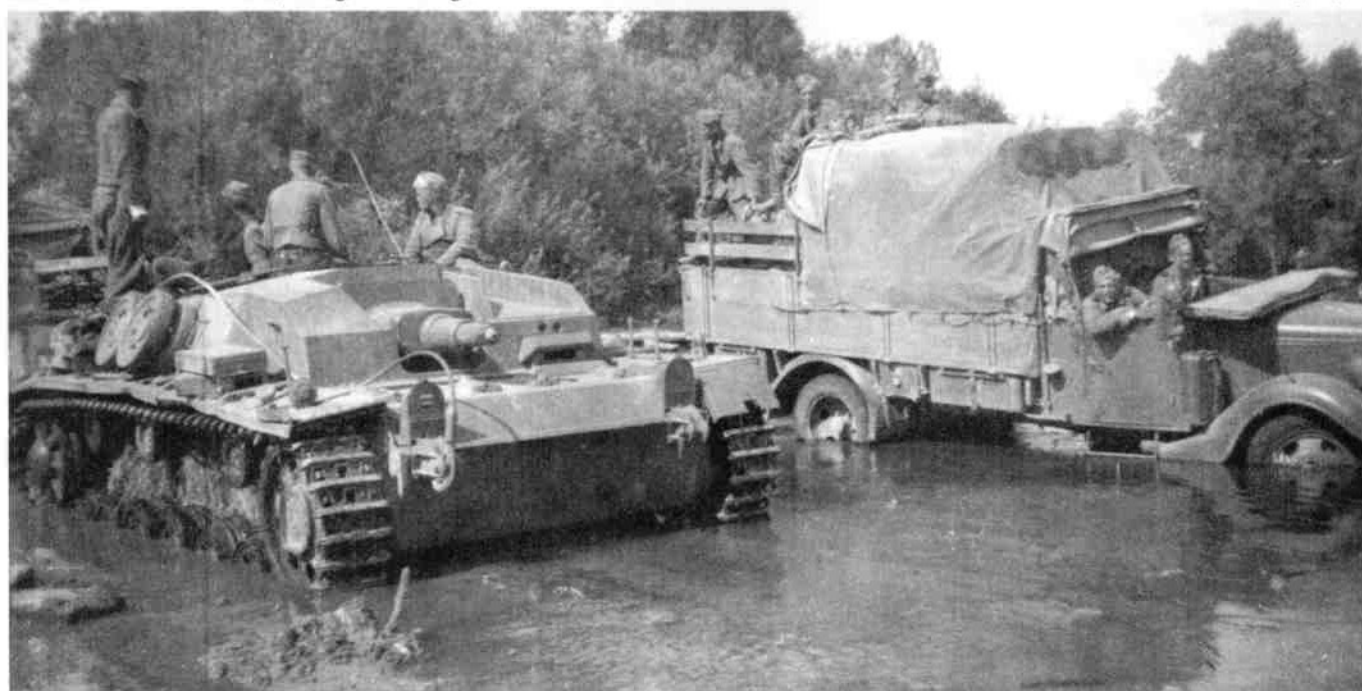
Dieses StuG III der späten Ausführung B muss Schlepphilfe für festgefahren Radfahrzeuge leisten. Rechts im Bild ist ein teilmilitarisierter 3-Tonnen-Lkw vom Typ Ford V8-51 erkennbar, dessen Besatzung geduldig wartet, bis auch sie aus der Furt gezogen wird. This Sturmgeschütz III of late Ausführung B gives a helping hand in recovering this partially-militarised 3-ton Ford V8-51 truck while the truck's crew waits for their "rescue". (HH)
