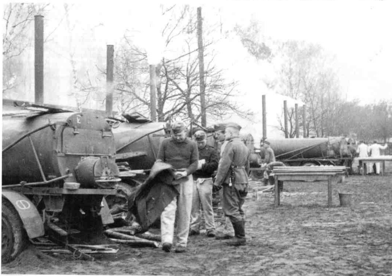
Erster modernerer Feldbackofen der Wehrmacht war der noch pferdebespannte, aber schon luftbereifte Sonder-Anhänger 105.
