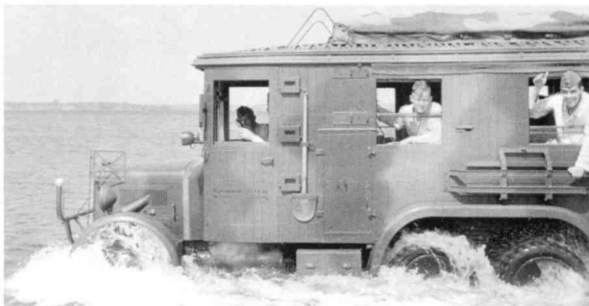
Dieser Fernsprechbetriebs-Kraftwagen Kfz. 61 hat zur Traktionsverbesserung Gleisketten auf den Hinterrädern montiert, obwohl das Gelände einen harmlosen Eindruck macht. This Fernsprechbetriebs-Kraftwagen Kfz. 61 signals truck has been fitted with tracks over the rear wheels to improve traction - despite the harmless terrain. (HH)
