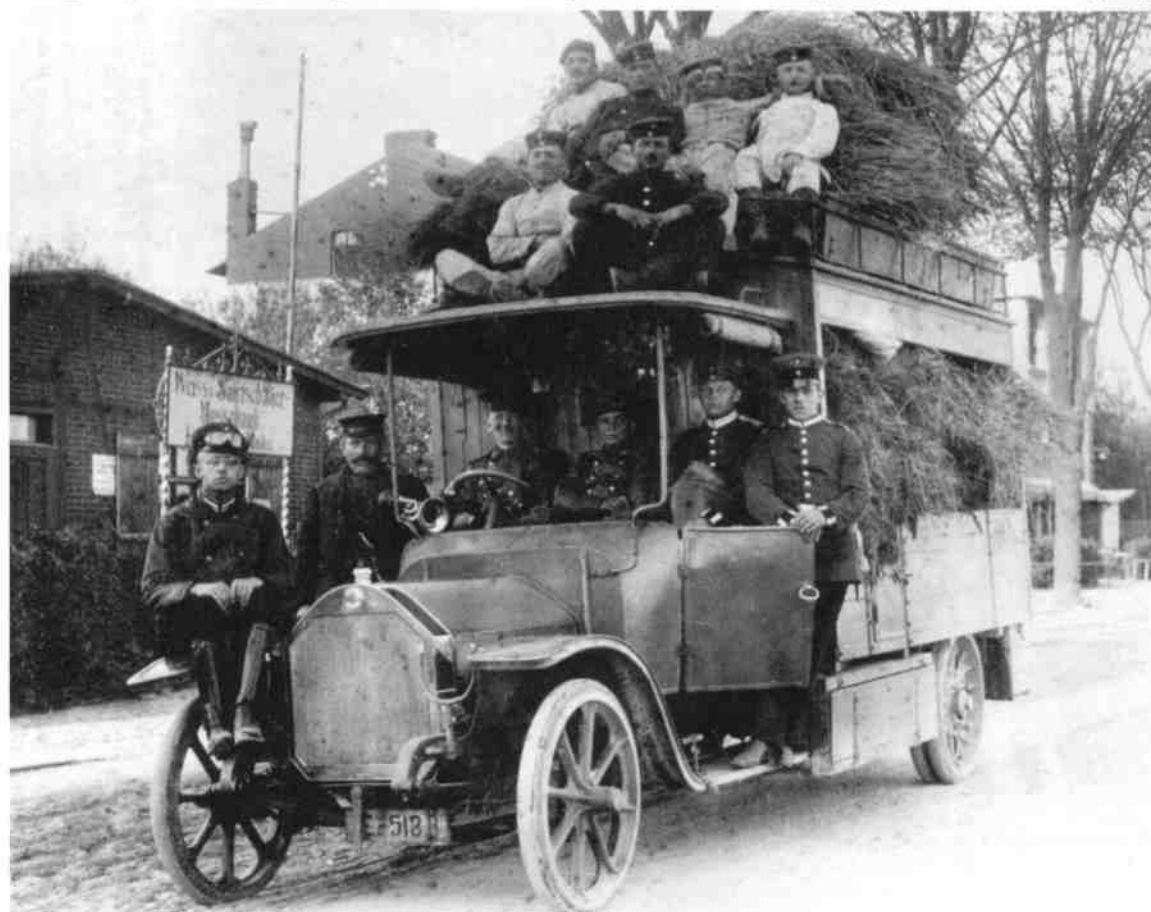
Rauhfutter-Transport bei der Flieger-Abteilung Döberitz bei Berlin. Auf der Basis eines requirierten Omnibus Benz Gaggenau Typ BO 10 vom 1912 fand der Truppen-Umbau in dieses Spezialfahrzeug statt. Transport of provender with the Flieger Abteilung Döberitz - aviation unit Döberitz - near Berlin. This formerly civilian Benz Gaggenau Typ BO 10 bus of 1912 had been converted to serve this highly specialised usage by the unit. (StS)
