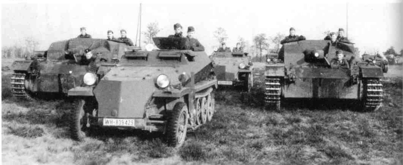
Feldparade einer Sturm-Batterie: ein Sd.Kfz.253 dient (noch) als Batterie-führer-Wagen, gefolgt von zwei StuG III Ausführung B und einem Sd.Kfz. 252. A parade in the fields. The Sd.Kfz. 253 armoured observation halftrack of the battery commander leads two Sturmgeschütz III Ausführung B and a Sd.Kfz. 252. (HH)
