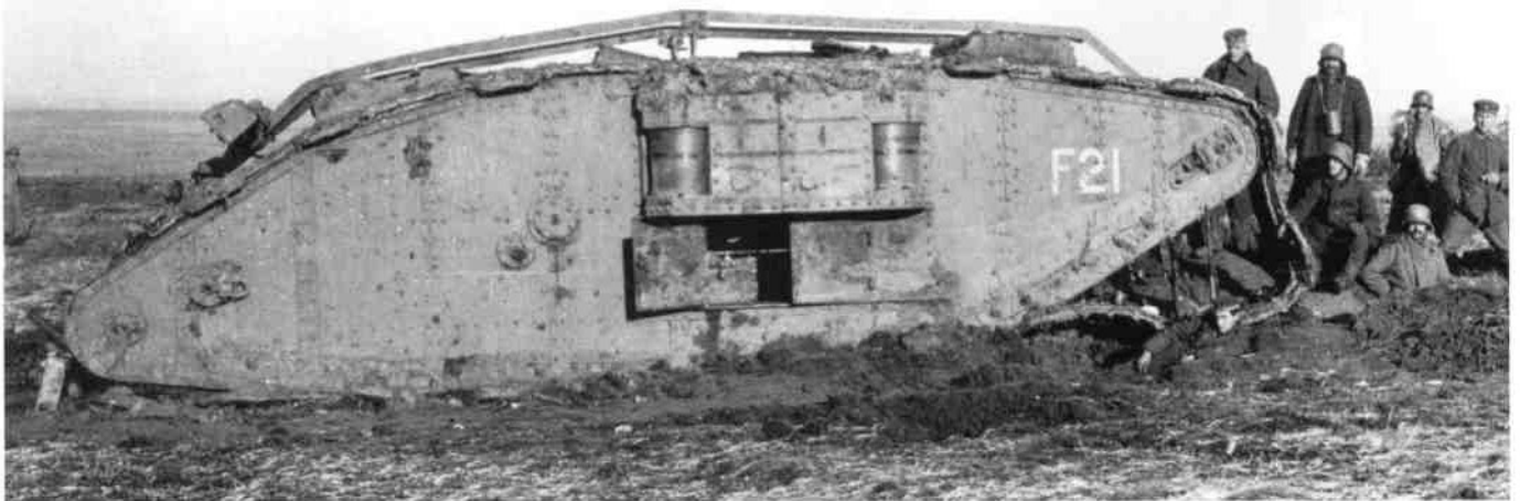
Am 31.01.1918 entstand dieses Foto von „F 21“ nahe Bourlois, Frankreich. Der Mk. IV „Female“ hat zwar einen Ketten-schaden, scheint aber sonst unbeschädigt und damit instandsetzungswürdig zu sein.
