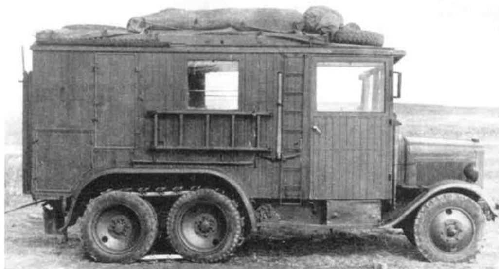
Diese Luftwaffen-Kolonnen verfügte in der Mehrzahl über mittlere gl. Lkw. Als Küchenwagen aber hielt sie sich einen G 31 mit improvisiertem Kofferaufbau und als Verpflegungswagen einen leichten (und seltenen) Lkw Typ Phänomen „Granit“. This Luftwaffe unit is mostly equipped with medium-weight trucks. The kitchen truck, however, is a G 31 with improvised shelter. Note also the very rare Phänomen "Granit" light truck here in the food-supply role. (HH)
