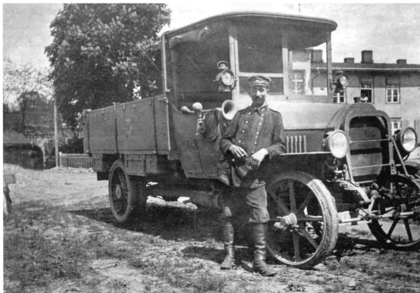
Beide Bilder auf dieser Seite zeigen den gleichen Typ, nämlich 3 to-Kardan-Lastwagen vom Typ DC 3 cl, gebaut zwischen 1915 und 1917 von Daimler Marienfelde. Während der oben abgebildete Wagen, einem Beerdigungskommando dienend, nagelneu erscheint, zeigt der untere, fotografiert im Juni 1917 in Cüstrin/Neustadt, schon einige Abnutzungserscheinungen. Both pictures on this page show the same 3-ton Kardan-Lastwagen Typ DC 3 cl, manufactured from 1915 to 1917 by Daimler Marienfelde. While the truck above belongs to a burial unit and is obviously brand new, the truck below, pictured in June of 1917 in Cüstrin/Neustadt, already shows some wear and tear. (HH)
