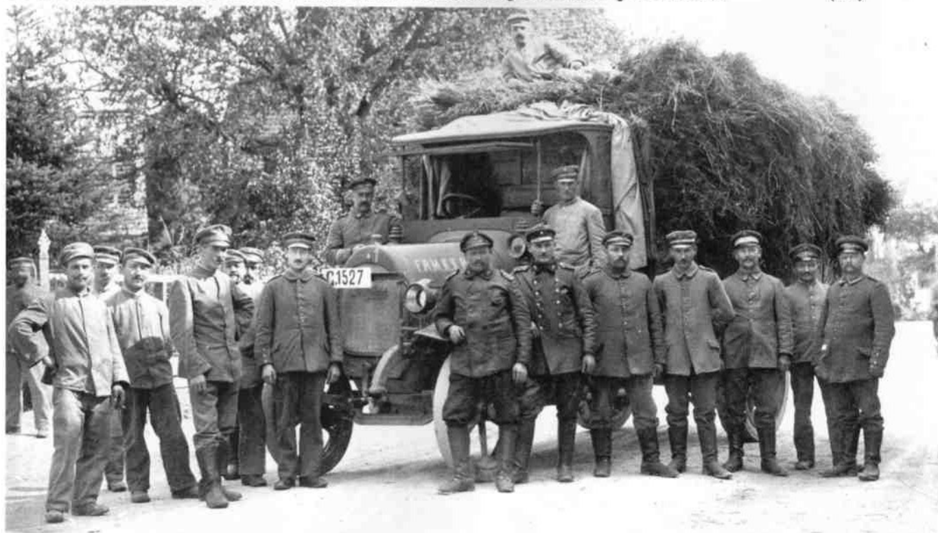
Dürkopp in Bielefeld war der Hersteller dieses Lkw der 3 to-Klasse. Die größtenteils pferdebespannte Deutsche Armee hatte einen enormen täglichen Bedarf an Rohfutter, welches man hier bis an die Grenzen des Machbaren geladen hat. To cope with the enormous amount of provender required for the mostly horse-drawn Imperial German Army, trucks such as this 3-ton Dürkopp manufactured in Bielefeld, Germany, where in heavy demand. (HH)
