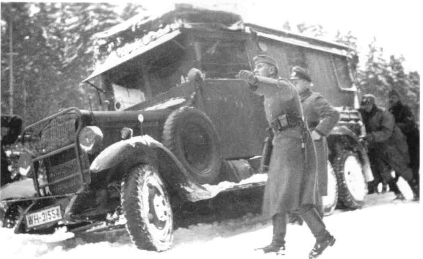
Datiert auf Februar 1938, ist dieser G 3a mit festem Aufbau in einen Graben geraten. Aufgrund der gut 5 to Gewicht bei nur 65 PS Motorleistung war Fremdhilfe zwingend nötig! Dated February 1938, this picture shows a Mercedes-Benz G 3a with fixed superstructure stuck on the roadside. The vehicle was severely underpowered with 65hp for its 5-ton weight. (HH)
