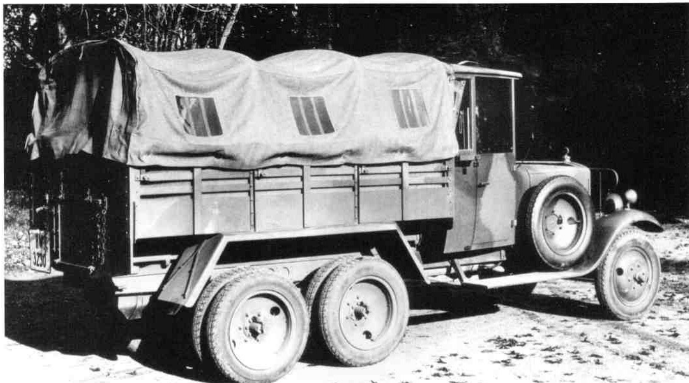
Dieses Foto von 1929 zeigt eine frühe Ausführung des Mercedes-Benz G 3a, noch mit festem Fahrerhaus versehen. Spätere Modelle mit Pritschenaufbau erhielten dann ein faltverdeck über der Fahrerkabine. This picture, taken in 1929, shows an early variant of the Mercedes-Benz G 3a still equipped with the closed cab. Later cargo types were issued with a foldable soft-top. (WO)
