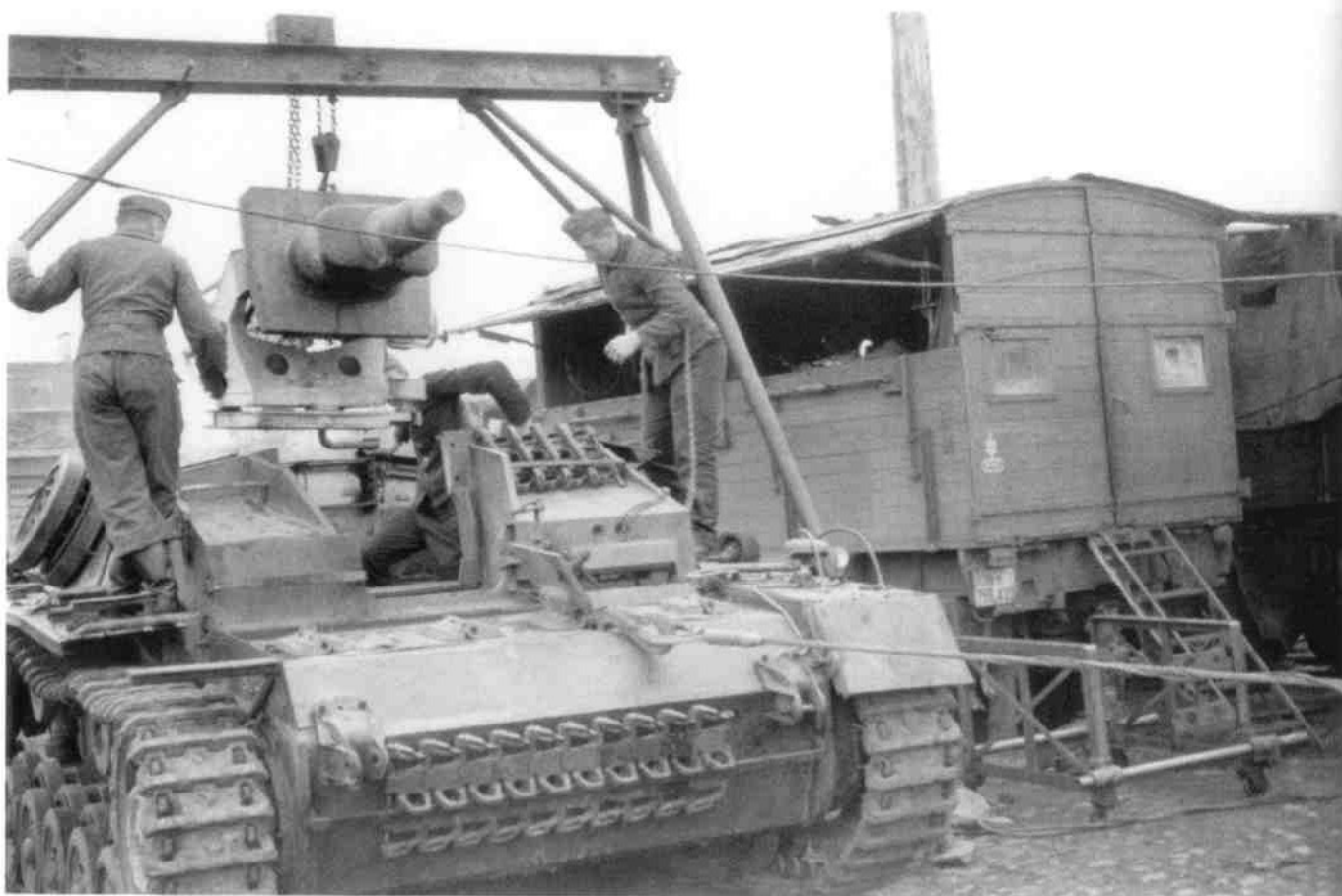
Diese Seite: Das bereits im Einband vorgestellte StuG III, Ausführung D, bekommt seine 7,5 cm-Sturmkanone L/24 zurück. Mittels S-Haken und Seilwinde hat man das Fahrzeug unter dem Kran in die richtige Position gerückt. This page: This Sturmgeschütz III Ausführung D has its 75mm Sturmkanone L/24 gun replaced using a maintenance truck. (TA)
